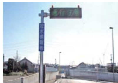
冠水時に通行止めをお知らせする冠水情報板
