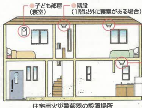
住宅用火災警報器の設置場所
