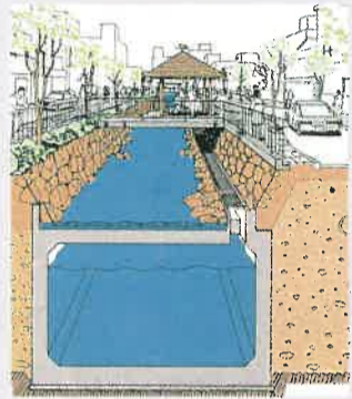
〔改修後の釜川の断面〕
