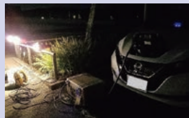
<避難所におけるEVからの給電>
